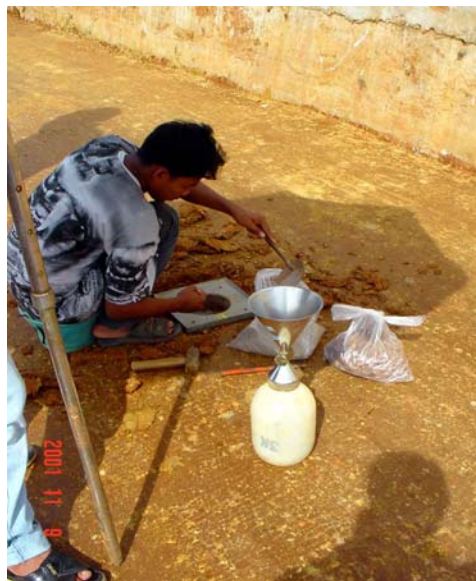
รูปที่ 9-11 แสดงการทดสอบความแน่นดินในสนาม
